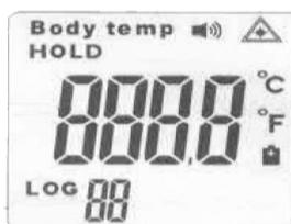
После завершения самоконтроля раздастся звуковой сигнал, указывающий на то, что температура измерена, и на жидкокристаллическом дисплее отобразится значение температуры тестируемого человека.
